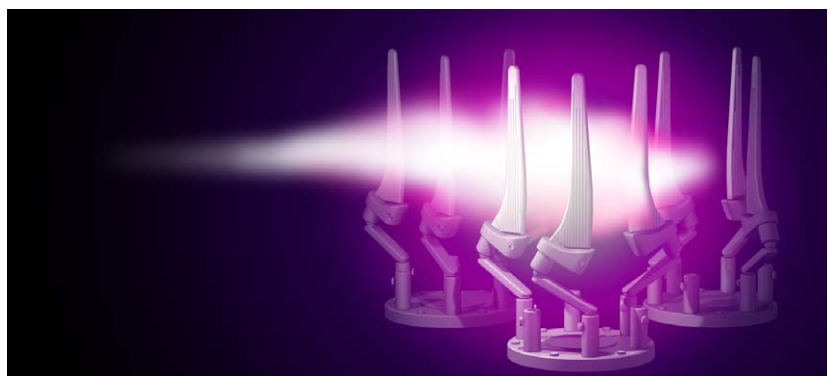
Bild 6b • VPS Plasmaspritzen
