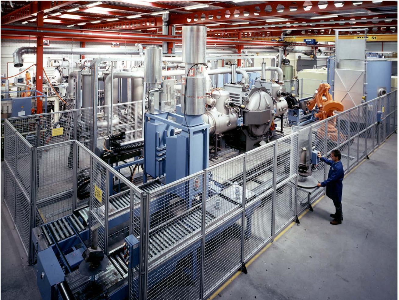
Bild 26 • Moderne LPPS Hochleistungs-Produktionsanlage zur Beschichtung von Gasturbinenschaufeln
