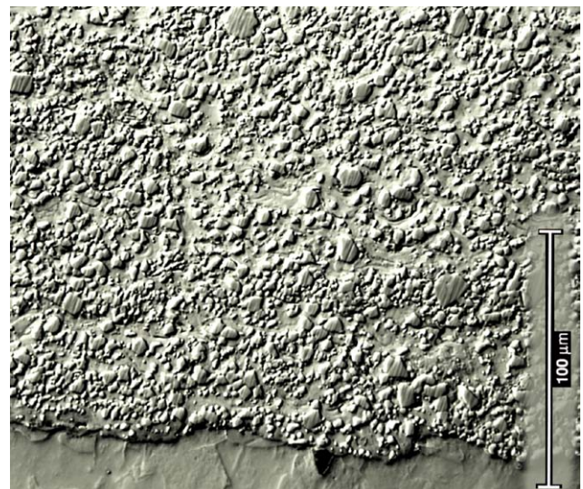
Bild 11 • HVOF-Spritzschicht aus WC-(Co,Cr)12
