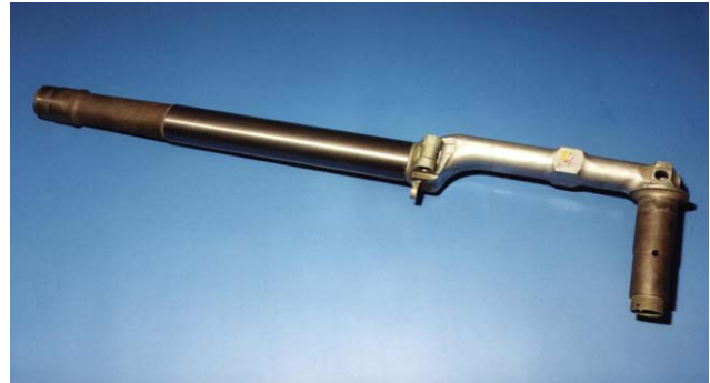
Bild 14 • Bugfahrwerk eines F5 Tigers mit WC/CoCr Beschichtung
