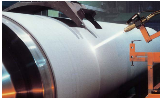
Bild 22 • HVOF Beschichtung einer Potrolle
