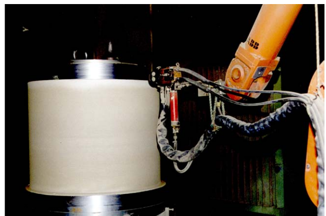
Bild 19 • Planetenachse mit Weissmetall beschichtet
